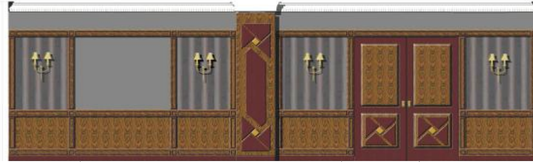
شكل (١٢) مسقط رأسي (C-C) (رسم هندسي) بالقاعة متعددة الأغراض حيث يوضح تصميم حائط المدخل للقاعة من الداخل
